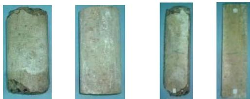
写真-4 10%硫酸ナトリウム溶液中に浸せきしたコンクリートの劣化状況（材齢12ヶ月間）
