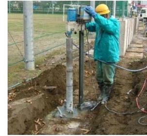
写真-3 土中養生した供試体からコアを採取している状況
