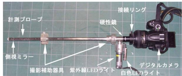
写真-1 構造物検査用内視鏡の構成
