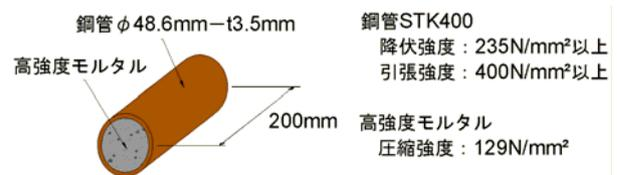
図-5 高強度コアジベルの概要
