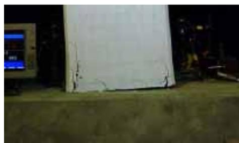
写真 - 4 最大応答変位時の基部周辺のひび割れ状況
