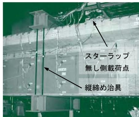
写真-1 スターラップ無し側せん断破壊後の PC 鋼棒を用いた縦締め治具の設置状況
