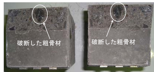
図-10 部材厚 40mm 供試体の破壊面
