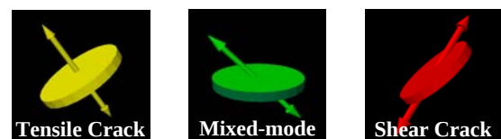
図-1 SiGMA 解析に用いるクラックモデル
