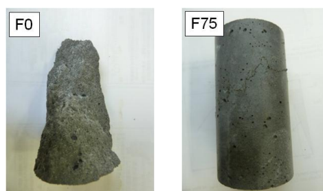
図—6 破壊した円柱試験体
