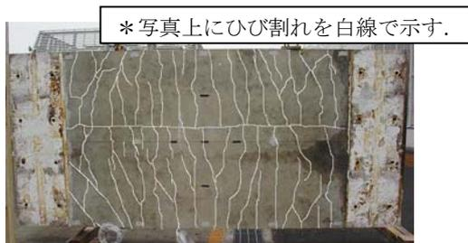
図-14 試験体裏面のひび割れ状況(加熱終了後)
