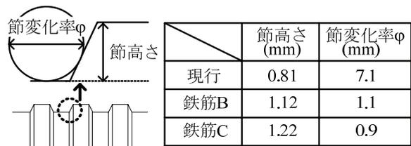
図-3 使用鉄筋節形状
