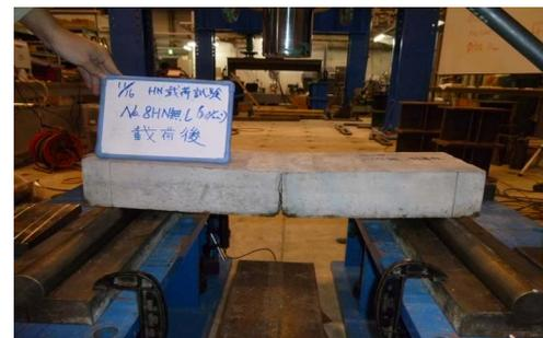
写真-3 一点荷重試験後の供試体 (No. 8) の状況
