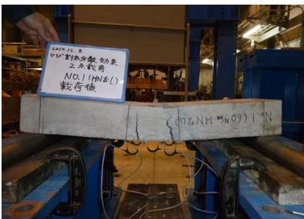
写真-5 2点荷重試験後の供試体(No.1)の状況
