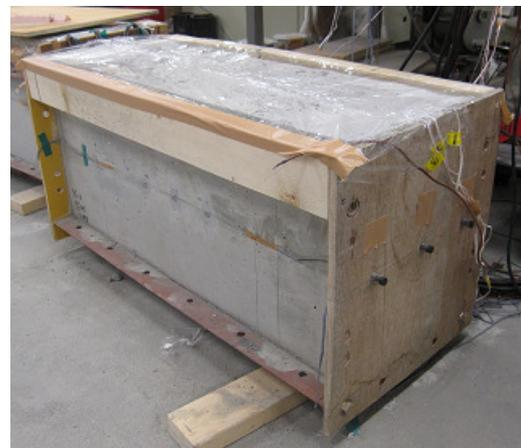
図-3 乾燥収縮ひずみ供試体
