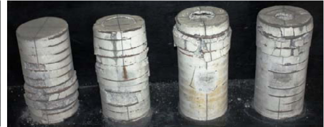
(b) BH27シリーズ (Pw=3.11%) (左から支圧径(B)=145, 100, 75および50mm)
