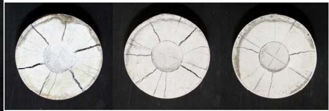
(a) Pw=1.33% (b) Pw=2.13% (c) Pw=3.07% 写真-3 鋼管モルタルの最終割裂ひび割れ状況の例 (支圧径(B)=50mmの場合)
