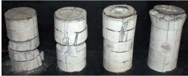
(a) BH60シリーズ (Pw=1.41%) 写真-4 帯筋モルタルの最終破壊状況の例
