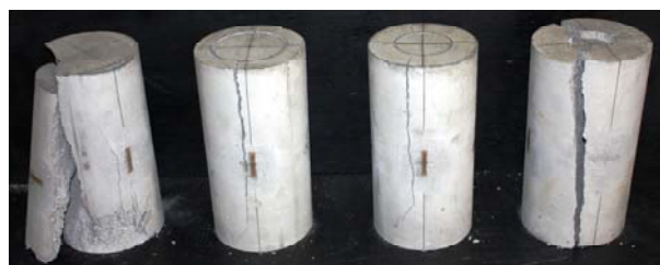
写真-1 プレーンモルタルの最終破壊状況( P_w=0.00\% ) (左から支圧径(B)=145, 100, 75および50mm)
