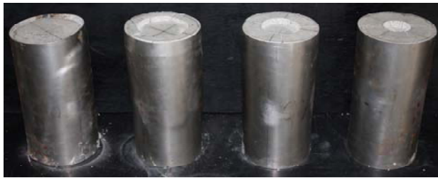
写真-2 鋼管モルタルの最終破壊状況の例 (Pw=1.33%) (左から支圧径(B)=145, 100, 75および50mm)
