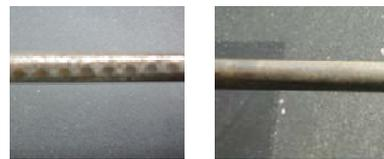
図-3 鋼材の表面状態（左：異形鋼線、右：丸鋼）
