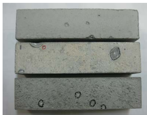
写真-5 供試体の打設面の状況
