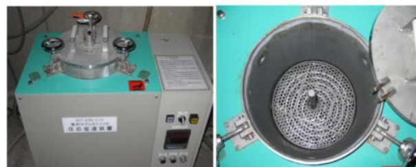
写真-2 促進試験に使用した反応促進装置（JIS A 1804）
