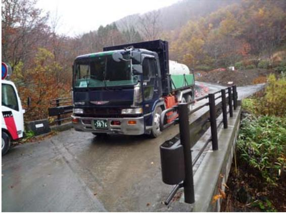
写真-3 ダンプトラックによる静的荷重試験
