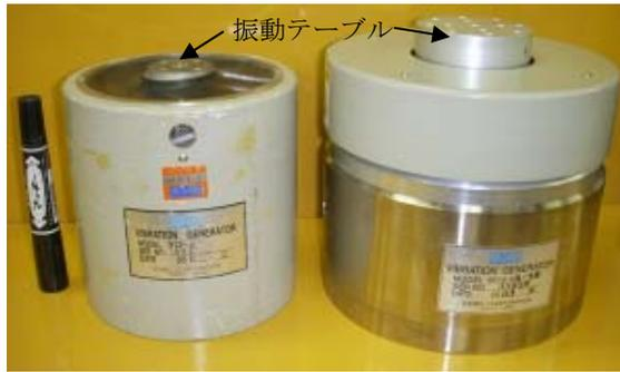
写真-1 小型起振機 (左: Type A, 右: Type B)
