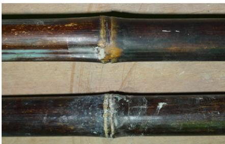
写真-7 試験終了後の節の状態 ( $\phi 16$ )
