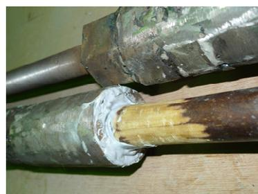
写真-3 PC鋼棒と竹材の接合部
