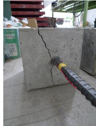
写真-4 異形鋼による破壊状況 (D19)
