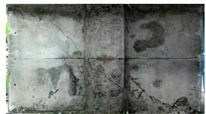
写真-2 裏面の最終破壊状況 (No. 3)
