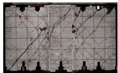
最終破壊状況 (R=+1/100rad. 1 回目)
