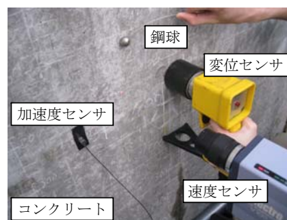
写真-3 衝撃弾性波法の計測状況
