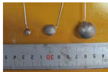
写真-2 弾性波の入力に用いた鋼球
