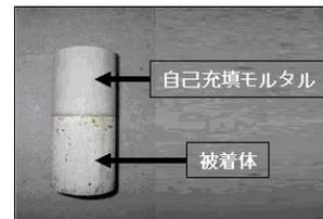
写真-1 せん断付着強度試験用供試体
