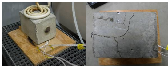
写真-2 誘導加熱後の試験体のひび割れ状態一例
