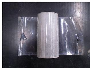
写真-3 ひび割れを防いだ供試体
