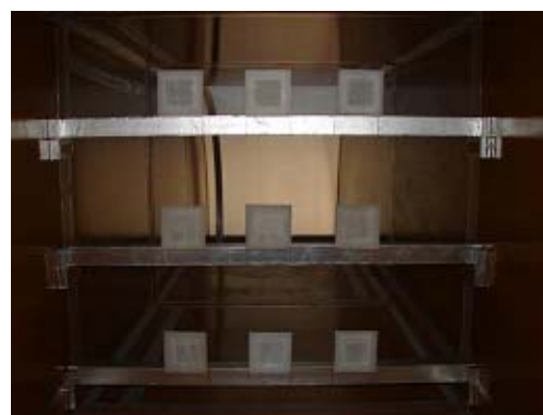
図－4 ガーゼ供試体の暴露状況 (二階供試体設置位置)
