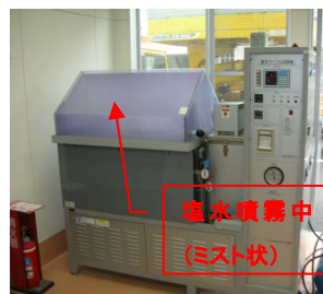
写真－1 複合サイクル試験機の外観
