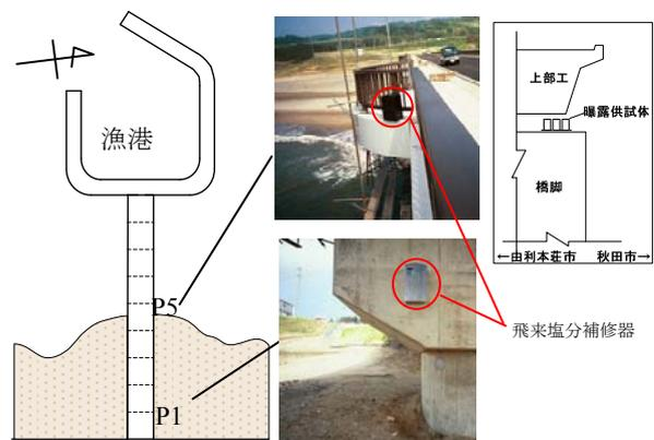
図-1 飛来塩分捕集器設置箇所と供試体設置状況 (岩城アイランドブリッジ)
