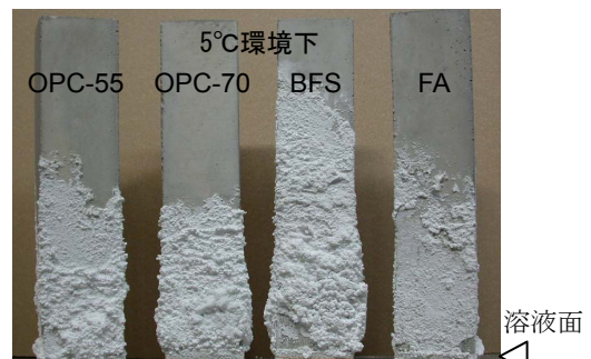
写真-1 住宅基礎コンクリートの劣化状況（一例）
