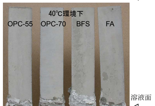
写真-2 浸漬試験後の各供試体の外観
