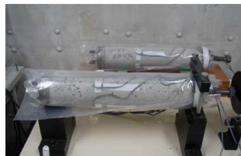
写真-2 非乾燥コンクリート供試体
