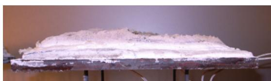
写真-3 耐火塗料材試験後の状態
