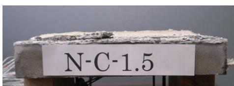
写真-5 耐火塗料材試験後の状態
