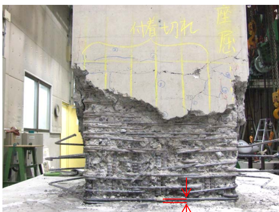
写真—6 試験終了後の軸方向鉄筋の状況 （載荷面：SP筋切断後）
