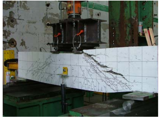
実験：最終破壊状況
