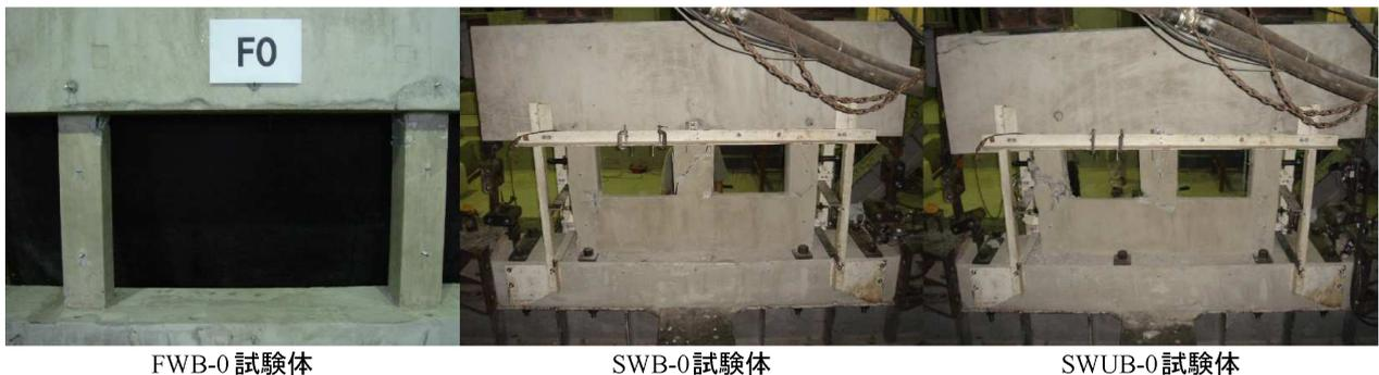
図-9 各試験体の実験終了時のひび割れ状況写真(1)
