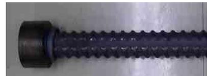
図-4 本研究で用いた機械式定着
