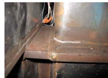
写真 - 3 3WSO 柱脚亀裂 (R=1.75/100rad.)
