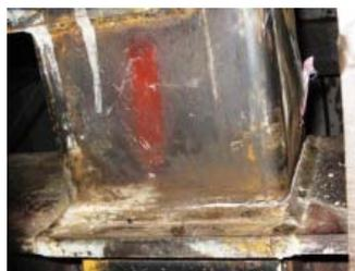
写真 - 2 3WCO-2 柱脚亀裂 (R=1.75/100rad.)
