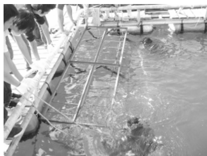
写真-2 試験体沈設作業
