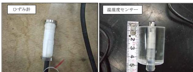
写真-1 埋設した温湿度計ユニットとひずみ計
