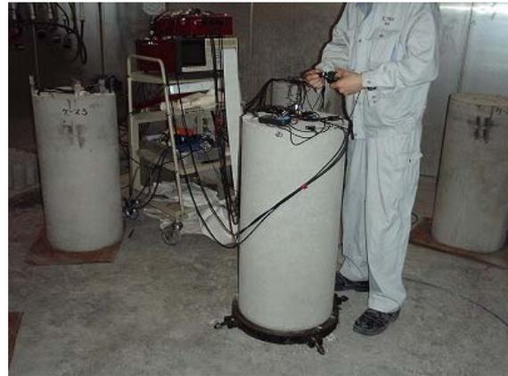
写真-2 促進養生室内の大型円柱供試体
