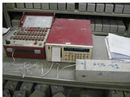
写真-2 埋め込みゲージのひずみ測定
