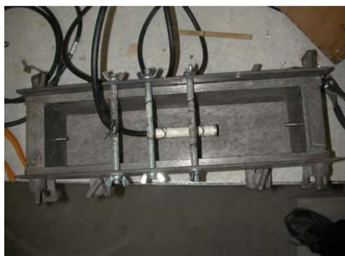
写真-1 埋め込みゲージの配置
