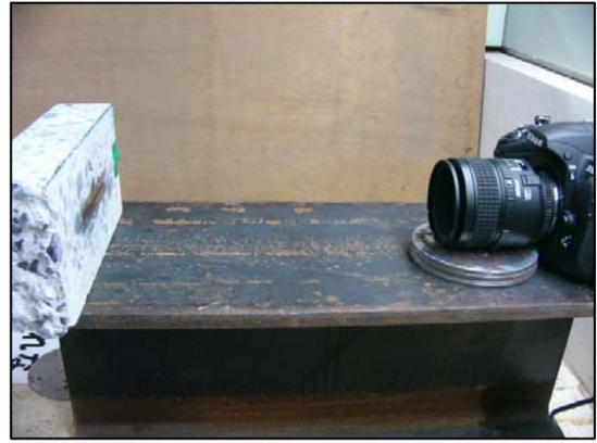
写真-2 乾燥収縮試験と画像撮影の様子
