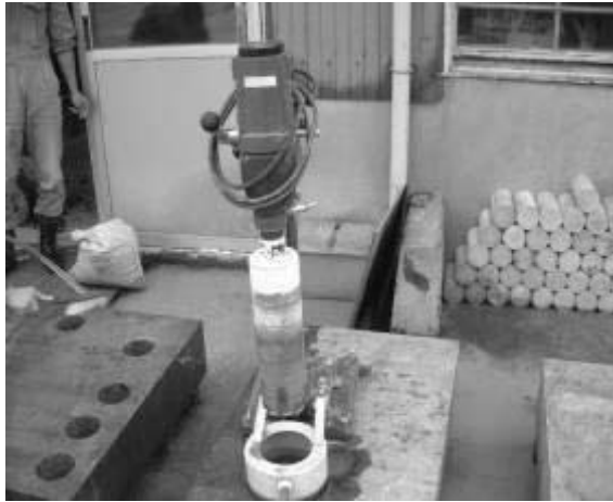
写真-2 コア供試体採取前の曝露供試体
