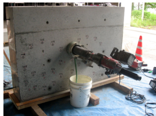
写真-1 壁部材からのコア採取状況
