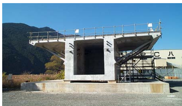
図－11 ストラットに支持された床版載荷実験
