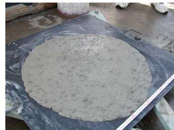
写真-2 スランプフロー試験状況 (61.5cm, 杭5)
