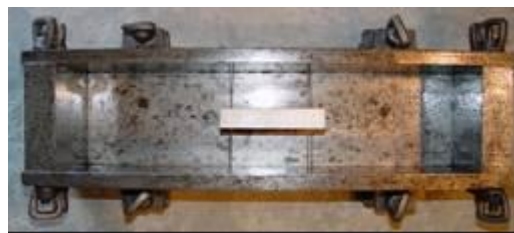
写真-1 供試体型枠
