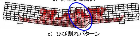
図-11 補強試験体 3 解析結果
