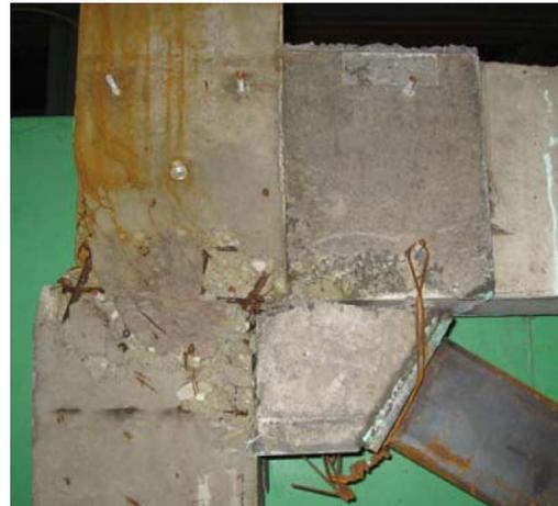
写真 - 1 07RP 試験体の破壊状況 (実験終了後)
