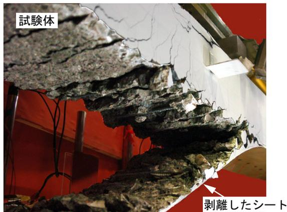
写真-2 シート剥離後の載荷点近傍下縁部の状況
