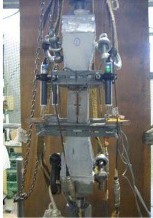
写真-1 FRCC 一軸引張試験
