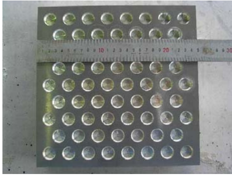
写真-1 ディンプル仕様のアルミ耐圧板
