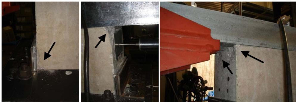
写真-2 PCd 試験体(1) 写真-3 PCd 試験体(2) 写真-4 PCe 試験体 (→ 破損部分)
