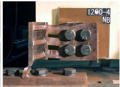
(f) 回転変形部の破断 (試験体 1200-IV)
