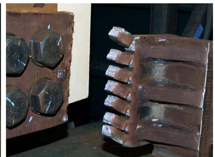
(c) せん断変形部の破断面 (試験体 1000-I)
