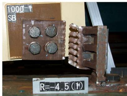
(b) せん断変形部の破断 (試験体 1000-I)
