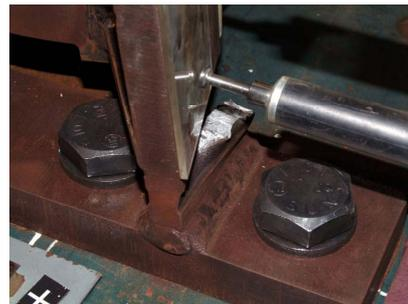
(d) 回転変形部のねじれ (試験体 1200-IV)
