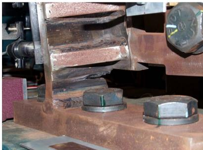
(d) 回転変形部の亀裂 (試験体 1200-IV)
