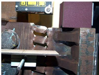
(a) 破断直前のせん断変形部 (試験体 1000-I)
