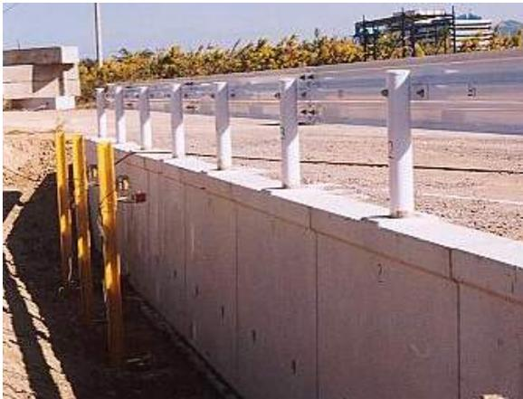
写真-2 実車衝突試験体の設置状況
